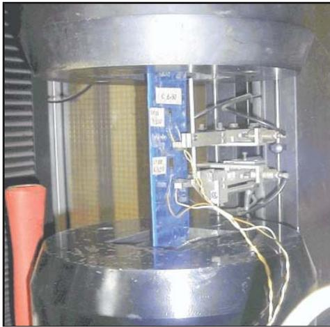
Setup di prova secondo ASTM D3039
