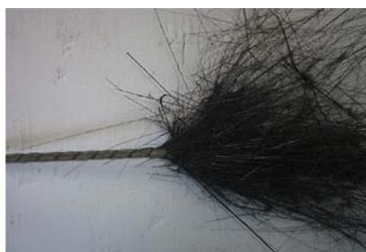
Rottura delle barre in CFRP (fibra di carbonio)
