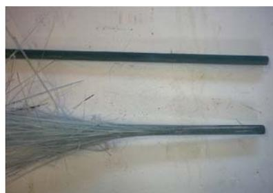
Rottura delle barre in GFRP (fibra di vetro)
