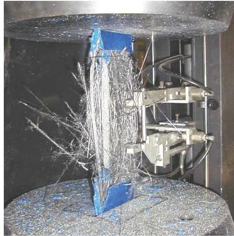
Tipo di rottura esplosivo di materiale CFRP
