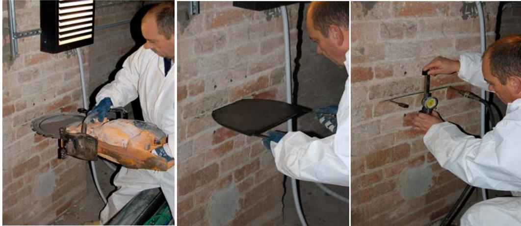
Figura 1: Taglio, installazione del martinetto singolo e lettura della convergenza a cavallo del taglio
