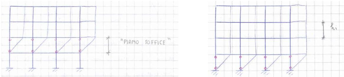
Questo tipo di meccanismo, caratterizzato da cerniere localizzate all'estremità dei pilastri di un solo interpiano (che possiamo quindi definire meccanismo di piano), comporta una ridotta capacità dissipativa, sia per lo scarso numero di cerniere plastiche che si formano, sia per il fatto che tutte le sezioni che si plasticizzano sono pressoinflesse, e quindi dotate di scarsa duttilità per la presenza dello sforzo normale.
