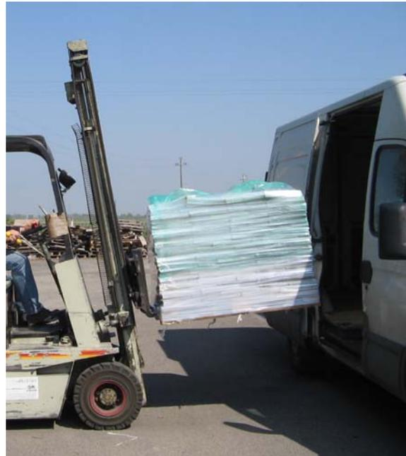
Oppure è possibile utilizzare una forca (anche non a norma UNI EN 13155:2007 purchè l'altezza di utilizzo sia inferiore a 1,50 metri)
