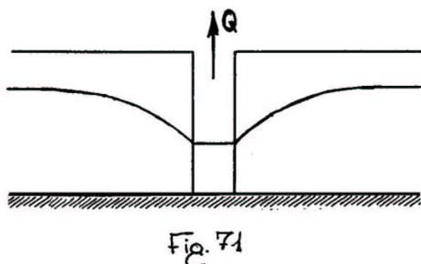
Viene realizzato un pozzo dal quale viene emunta una portata  $Q$ . Così si deforma il pelo libero della falda.
