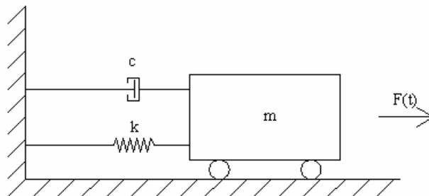
Questa schematizzazione semplificata permette di capire alcuni concetti base dell'analisi ma è anche il modello fondamentale che costituisce il sistema strutturale nel suo insieme.
